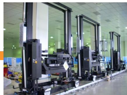
LCD無塵室自動 倉庫及生產搬送 系統
